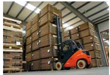
In de nieuwe, onverwarmde opslaglocatie kan hoger worden gestapeld en daarom zijn de nieuwe trucks voorzien van een driedelige mast en een comfortabele cabine
