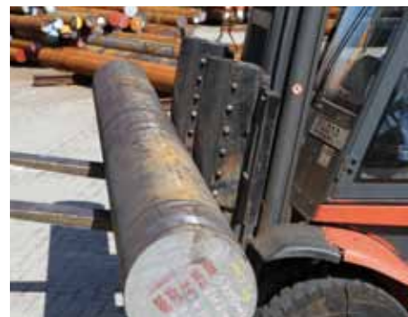
Dankzij de stootrubbers in de hiel van de vork krijgen de chauffeurs bij de handling van massief rondstaal geen zware klappen meer te verduren
