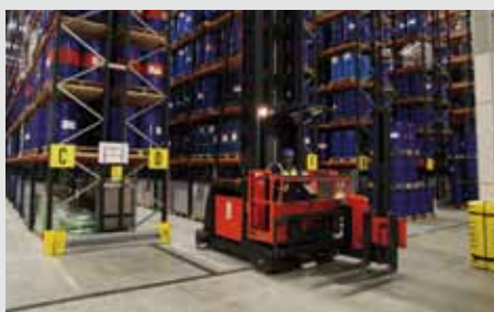
Bij geen gangwissel zoekt de smallegangstruck vanzelf de inductiedraad weer op
