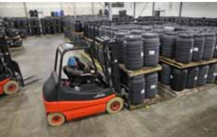
Met de 2,5-tonners van Linde worden twee pallets tegelijk opgepakt
